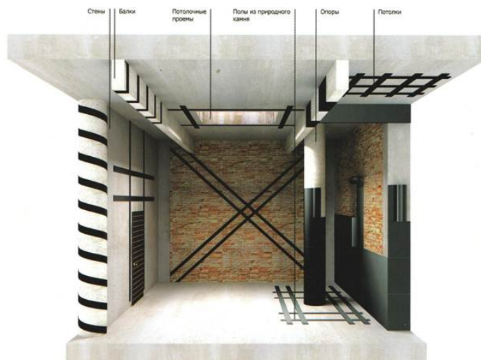
Рис. 4 Пример усиления конструкций углеволокном
