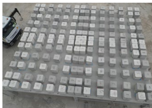
Рис. 6. Натурные испытания сталефибробетонного перекрытия. Figure 6. Real scale testing of SFRC flat slab
