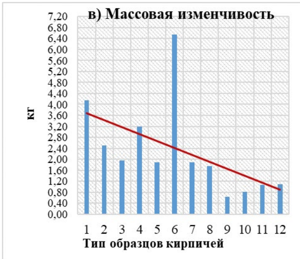
Рис. 8 Характеристики кирпичей по типу образцов: в) массовая изменчивость; г) прочность кирпичей на сжатие Fig. 8 Characteristics of bricks by type of samples: c) mass variability; d) compressive strength of bricks
