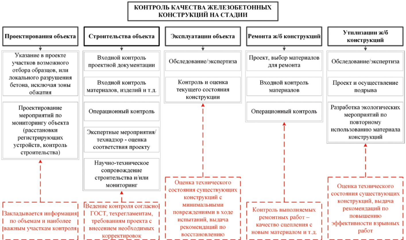
Рис. 2. Неразрушающий контроль на различных стадиях жизненного цикла Fig. 2. Non-destructive testing at various stages of the life cycle
