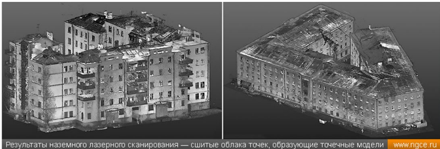
Рисунок 1 — Получение облака точек с помощью 3D сканера Getting a point cloud using a 3D scanner
