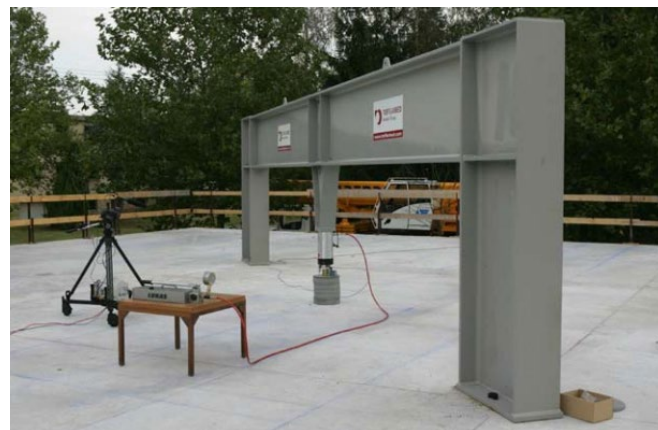
Рис. 5. Нагружение сталефибробетонного прототипа [9]. Figure 5. Loading of SFRC prototype
