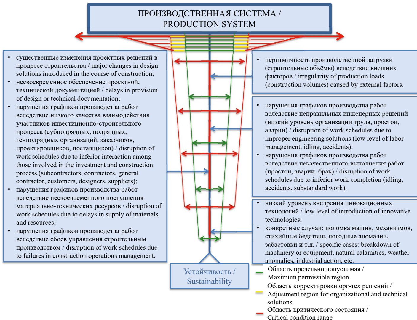
Рис. 1. Модель зависимости устойчивости производственной системы от рисков строительного производства Figure 1. The model of dependency between sustainability of a production system and the impact of risks of construction operations
