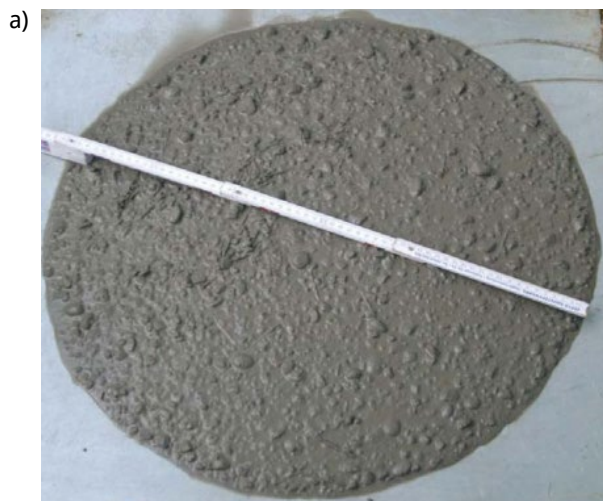
Рис. 4. а) Фибробетонная смесь; б) возведение прототипа. Figure 4. a) SFRC b) Construction of the SFRC prototype
