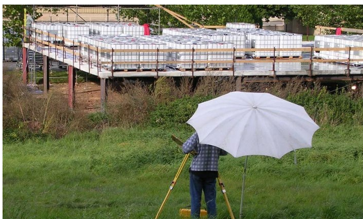
Рис. 5. Нагружение сталефибробетонного прототипа [9]. Figure 5. Loading of SFRC prototype
