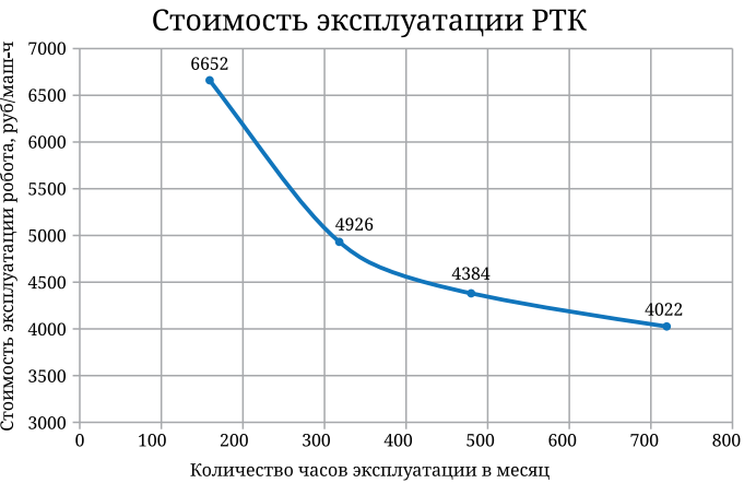
Рис. 2. График зависимости сметной стоимости эксплуатации робота для резервуара объемом 5000 м 3 от количества часов его использования в месяц Fig. 2. Graph of the estimated cost of robot operation for a 5000 m 3 tank depending on the number of hours of its use per month
