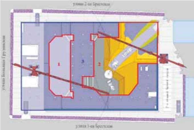
Рис. 3. План-схема строительства проекта полужакрытым способом Fig. 3. The construction plan by a semi-closed method
