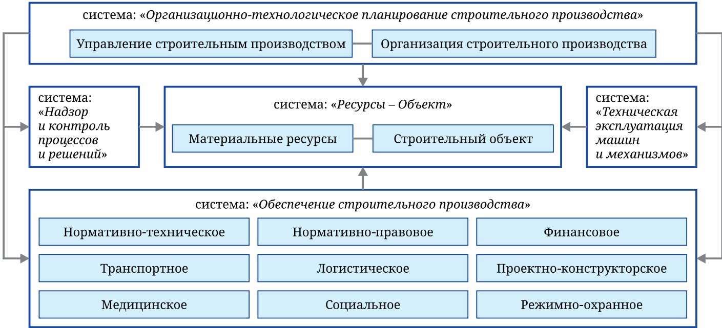
Рис. 2. Структура крупномасштабного инвестиционно-строительного проекта в его системотехническом (системном) отображении Fig. 2. Structure of a large-scale investment and construction project in its system (system) displaying
