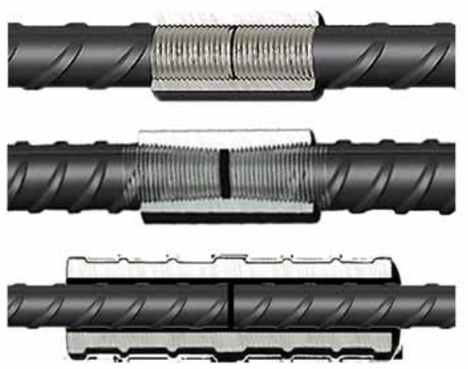
Рис. 4. Соединение арматур с помощью муфт Fig. 4. Connection of fittings with couplings
