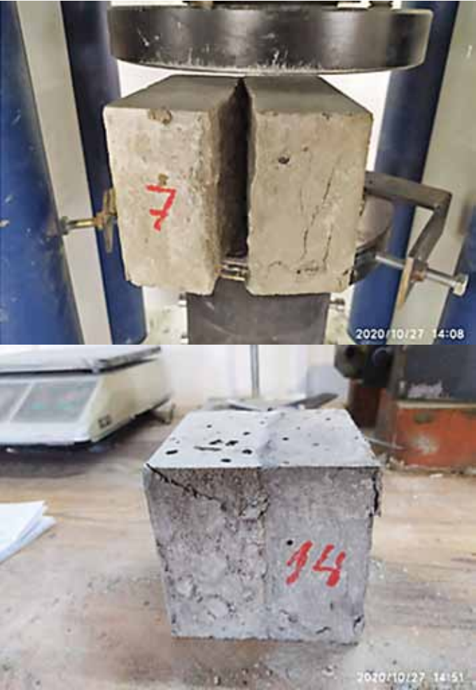
Рис. 7. Характер разрушения образцов при выдерживании по режиму 1/28: а) разрушение образцов с рН 7,1 по плоскости рабочего шва; б) разрушение образцов с рН 10,9 и 12,4 не по плоскости рабочего шва
