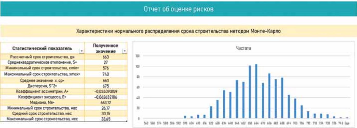
Рис. 3. Характеристики распределения срока строительства методом Монте-Карло Fig. 3. Characteristics of the distribution of the construction period by the Monte Carlo method
