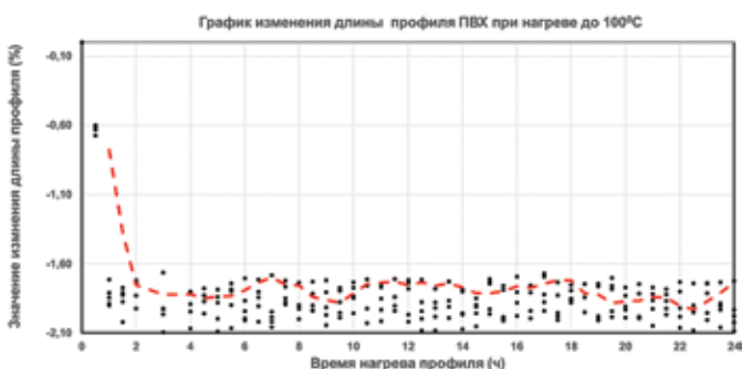
Рис. 11. График изменения длины профиля ПВХ при нагреве до 100 °С (профиль не эксплуатировался)
