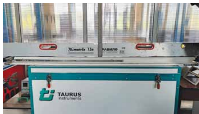
Рис. 2. Замер стрелы прогиба ПВХ-профиля в лабораторных условиях
