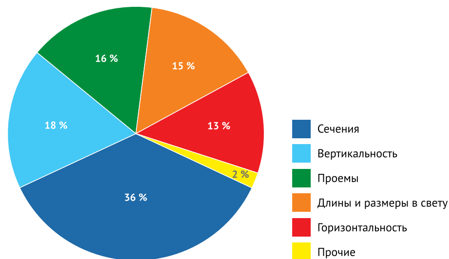
Рис. 3. Процент выявленных дефектов в монолитных железобетонных конструкциях по типам работ Fig. 3. Percentage of identified defects in monolithic reinforced concrete structures by type of work
