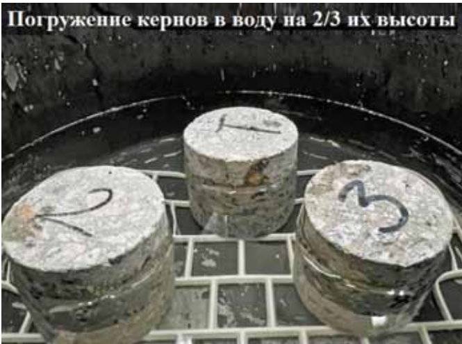
Рис. 2. Насыщение образцов по методике ГОСТ 10060-2012 Fig. 2. Saturation of samples according to GOST 10060-2012
