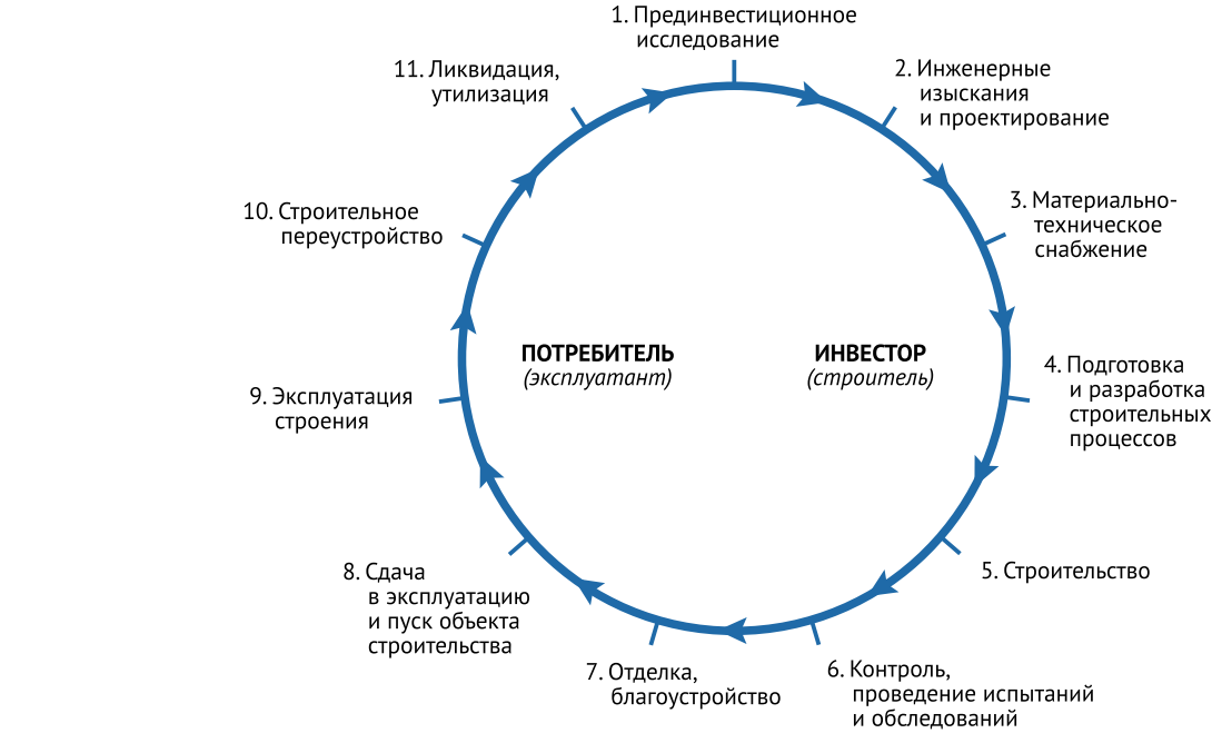
Рис. 1. Типовая модель жизненного цикла объекта строительства Fig. 1. Typical model of the life cycle of a construction object
