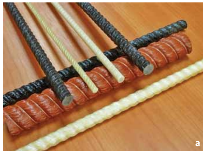
Рис. 1. Полимерная арматура: а) стержневая; б) в мотках Fig 1. Polymer reinforcements: a) bars; b) in rolls
