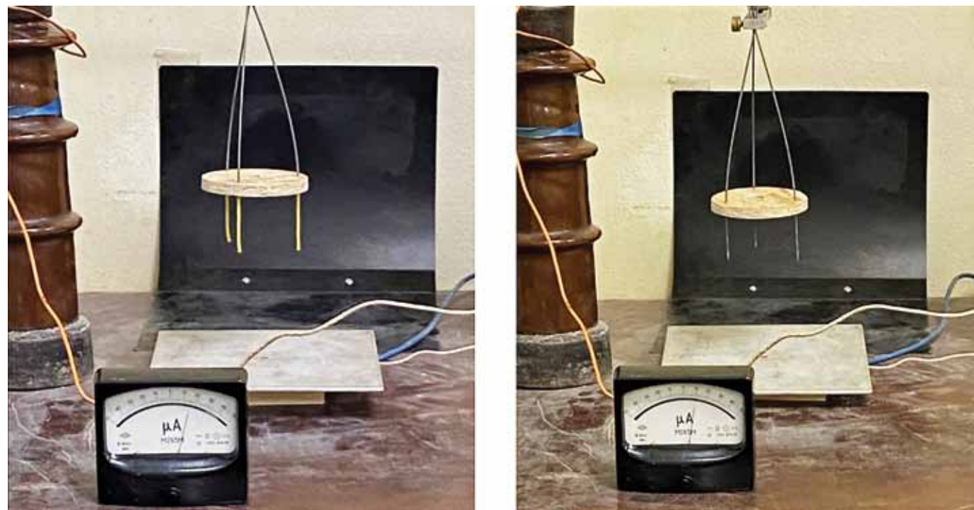
Рис. 2. а) Изолированные электроды, б) неизолированные электроды Fig. 2. a) Insulated electrodes, b) non-insulated electrodes
