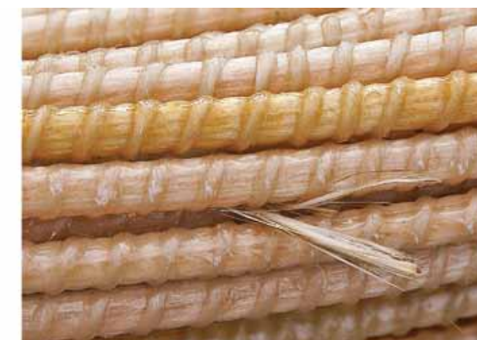
Рис. 2. Дефекты внешнего вида арматуры: а) трещины; б) обрывы волокон (источник: https://nauchite.com/2016/gfrp/ ) Fig 2. Defects of reinforcement appearance: a) cracks; b) broken fibers (source: https://nauchite.com/2016/gfrp/ )
