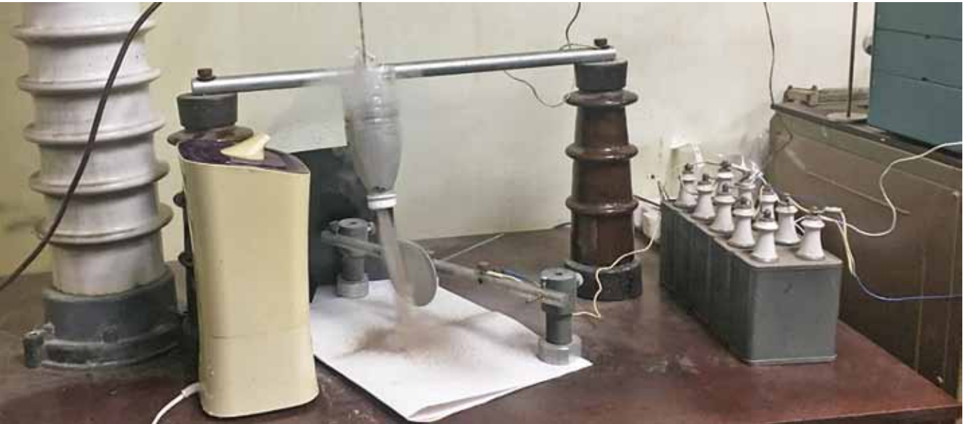
Рис. 1. Водоцементная смесь притягивается и осаждается на пластине конденсатора Fig. 1. The water-cement mixture is attracted and deposited on the capacitor plate
