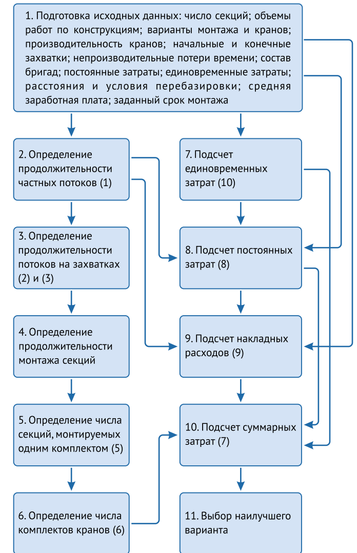
Рис. 2. Блок-схема методики выбора метода монтажа и комплекта машин при выполнении работ в определенный срок Fig. 2. Block diagram of the methodology for selecting the assembly method and machine set for completing work within a certain timeframe
