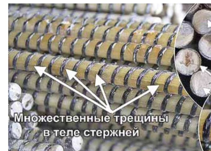
Рис. 2. Дефекты внешнего вида арматуры: а) трещины; б) обрывы волокон (источник: https://nauchite.com/2016/gfrp/ ) Fig 2. Defects of reinforcement appearance: a) cracks; b) broken fibers (source: https://nauchite.com/2016/gfrp/ )
