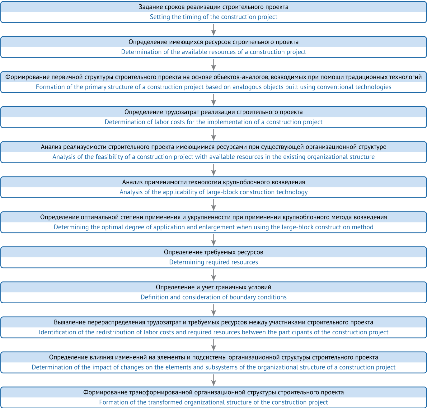
Рис. 1. Последовательность формирования организационной структуры проекта при крупноблочном возведении АЭС Fig. 1. The sequence of formation of the organizational structure of the project during the large-block construction of NPP
