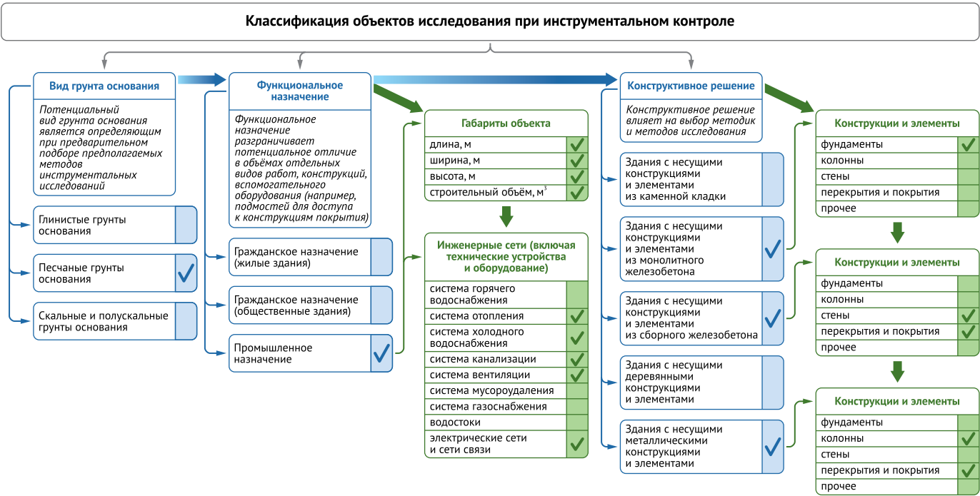
Рис. 2. Классификация объектов исследования при инструментальном контроле Fig. 2. Classification of research objects in instrumental control
