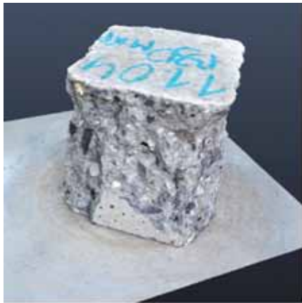
а) Результат фотограмметрии (куб после силового воздействия) a) Photogrammetry result (cube after force)
