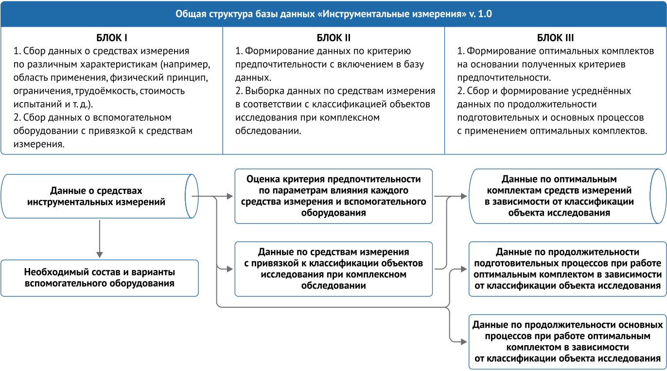
Рис. 3. Общая структура базы данных «Инструментальные измерения» Fig. 3. Basic structure of the database «Instrumental measurements»
