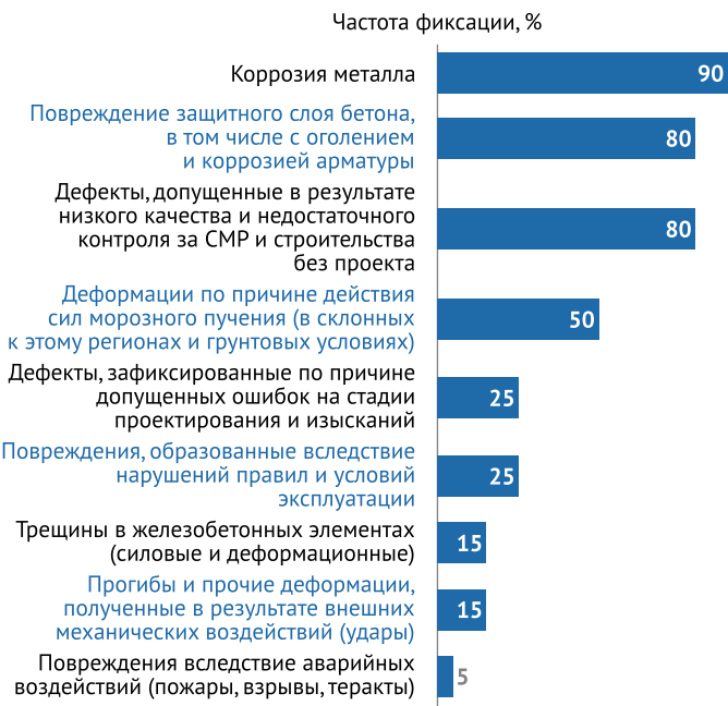
Рис. 15. Дефекты и повреждения, а также причины их появления, расположенные в порядке частоты фиксации на объектах обследования
