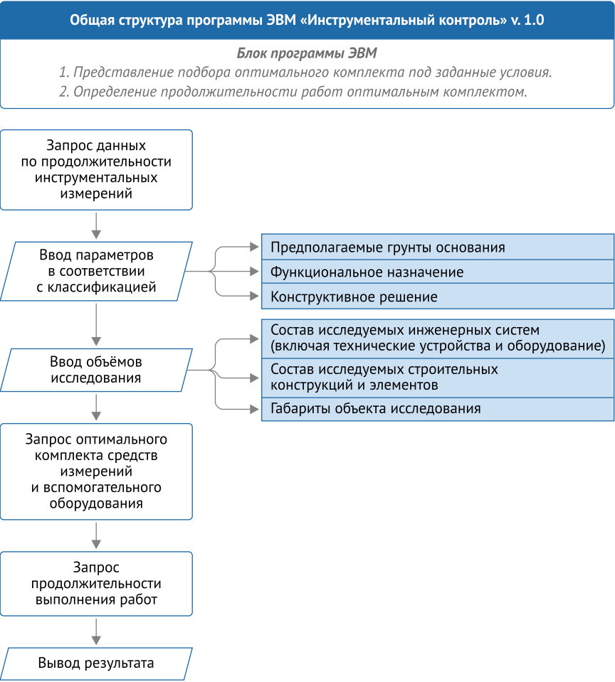
Рис. 4. Общая структура программы ЭВМ «Инструментальный контроль» Fig. 4. The basic structure of the computer program «Instrumental control»
