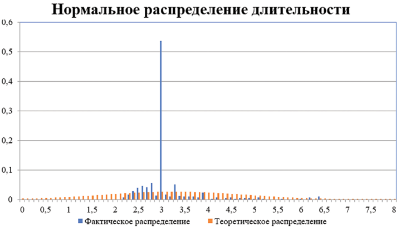
Рис. 1. Распределение общей выборки относительной длительности арматурных работ Fig. 1. Distribution of the total sample of relative duration of reinforcement works ну). Это сократило выборку до 432 работ, но значительно изменило статистические параметры: математическое ожидание стало 1,167, а среднеквадратичное отклонение – 0,653. Дальнейший анализ показал, что в исследуемой выборке значительная доля случаев характеризуется относительной длительностью, равной единице, то есть фактическим совпадением с плановой продолжительностью. Это обусловлено управляемым характером технологических процессов на строительной площадке. Поэтому целесообразно разделить выборку на два подмножества: 1) подмножество с распределёнными значениями и 2) подмножество с сосредоточенными значениями, равными или близкими к единице [13–14]. Из общего числа работ 222 (51,4 %) имели относительную длительность равную 1, что означает их завершение
