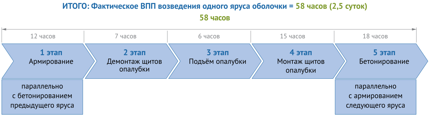
Рис. 4. Карта фактического состояния процесса после оптимизации Fig. 4. Actual process state map after optimization
