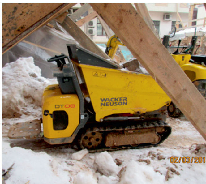
Рис. 2. Малогабаритная строительная техника для разработки грунтов в стесненных условиях
