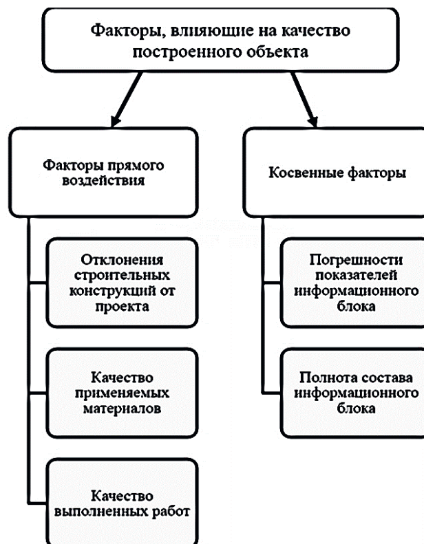
Рис. 2. Схема деления факторов, влияющих на качество построенного объекта на две группы
