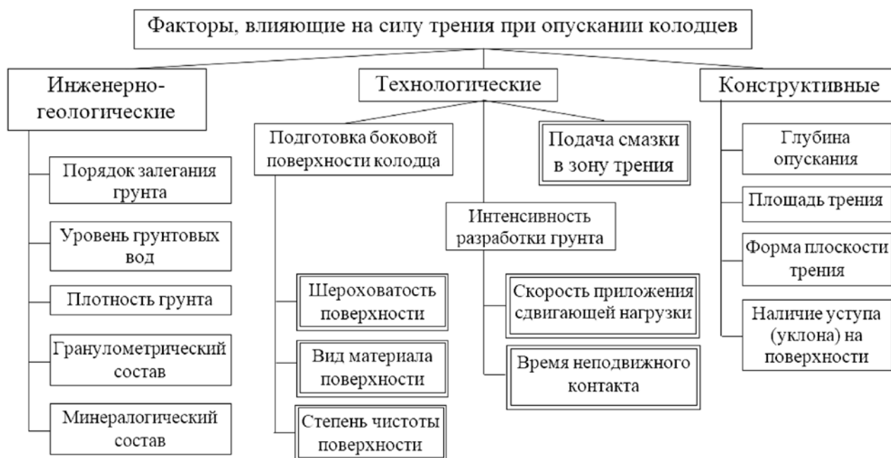
Рис. 1. Факторы, влияющие на статическую силу внешнего трения грунтов при опускании колодцев (двойной рамкой выделены управляемые технологические факторы) Fig. 1. Factors affecting the static force of external friction of soils when sinking wells (controlled technological factors are double-framed)
