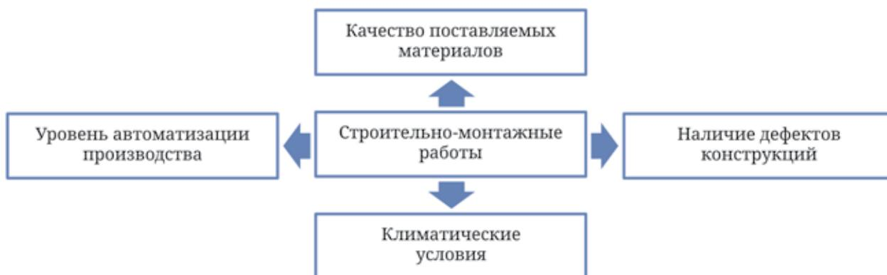
**Рис. 5.** Схема основных параметров, составляющих комплексный показатель качества на этапе строительно-монтажных работ
