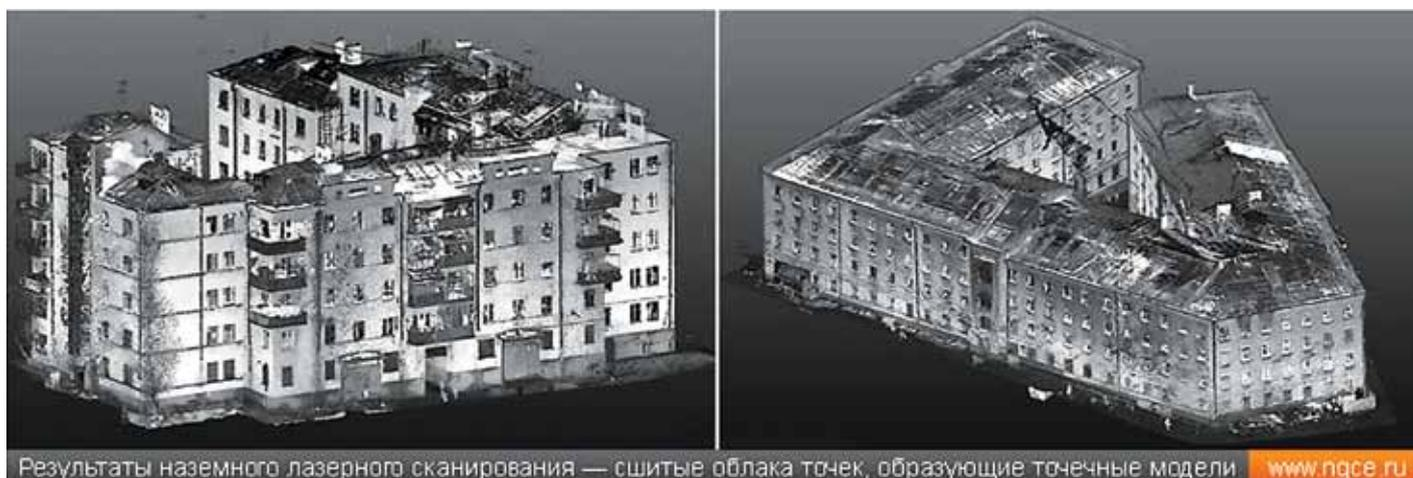
**Рис. 1.** Получение облака точек с помощью 3D-сканера
