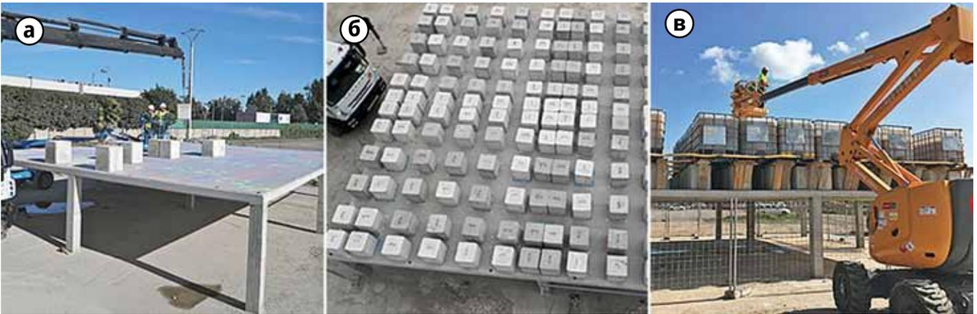
**Рис. 6.** Натурные испытания сталефибробетонного перекрытия
