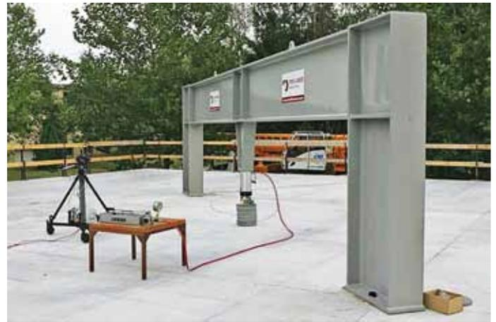
**Рис. 5.** Нагружение сталефибробетонного прототипа [9].
