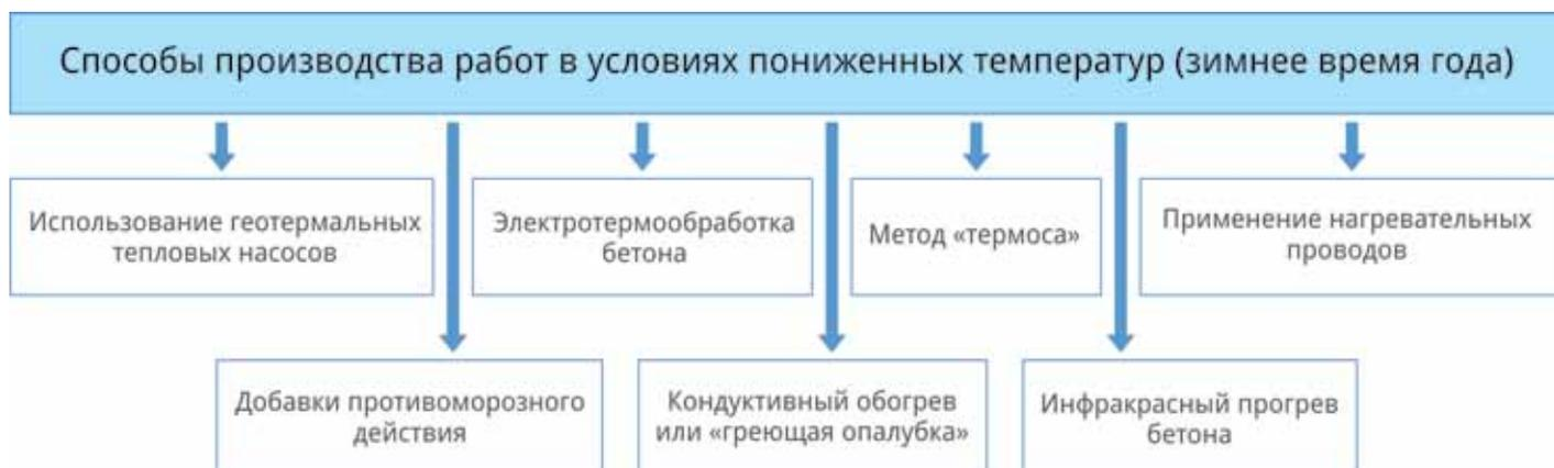
Рис. 1. Способы производства бетонных работ в условиях пониженных температур
