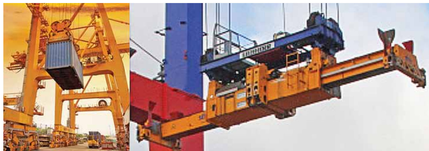
Рис. 1. Подъем грузового контейнера траверсой с зацепкой за верхний угловой фитинг Fig. 1. Freight container lifting with a crosspiece with hooking the upper corner fitting
