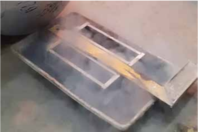
Рис. 4. Начало заморозки контрольного образца Fig. 4. Start freezing the control sample
