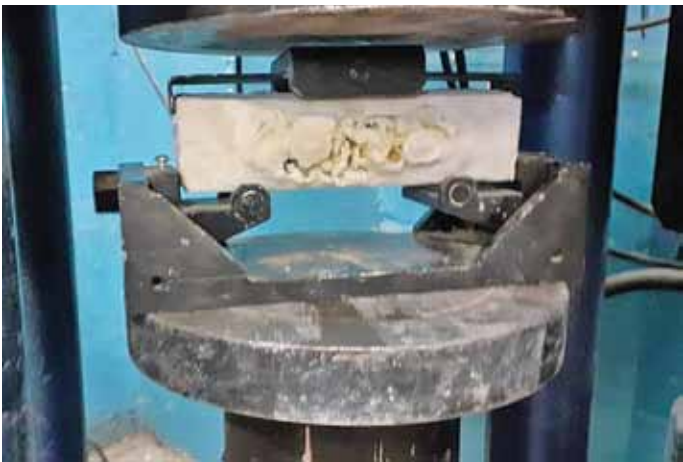
Рис. 6. Фиксация испытываемого образца на опорах испытательной машины
