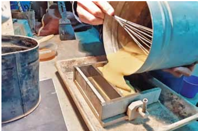
Рис. 3. Укладка раствора Fig. 3. Laying mortar
