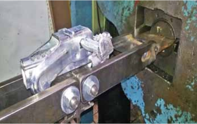
Рис. 4. Общий вид замка перед испытанием Fig. 4. General view of the lock before testing
