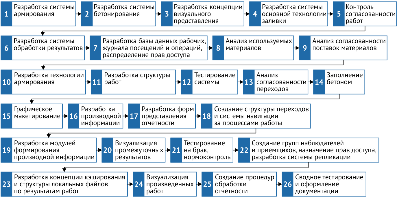
Рис. 8. Последовательность исполнения двумя бригадами бетонных и арматурных работ Fig. 8. The sequence of execution by two teams of concrete and reinforcement works
