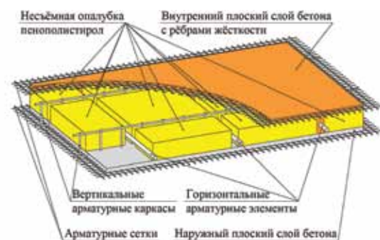
Рис. 2. Регулярная зона трехслойной конструктивно-силовой схемы монолитной стены сборного мобильного крупногабаритного модуля
