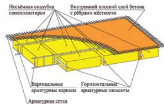
Рис. 3. Регулярная зона двухслойной конструктивно-силовой схемы монолитной стены сборного мобильного крупногабаритного модуля
