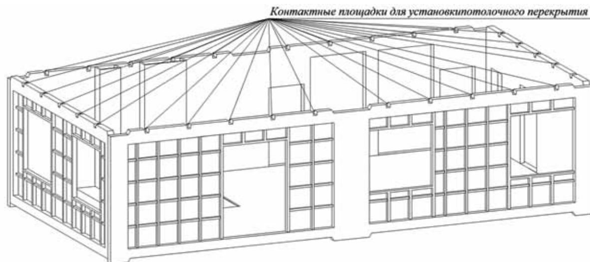
Рис. 14. Общий вид мобильного крупногабаритного модуля до установки потолочной плиты и монтажа перегородок и сантехкабин
