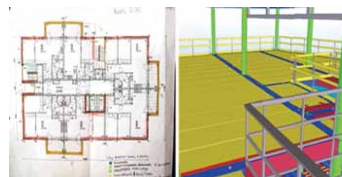
Рис. 2. Пример традиционного подхода к разработке плана безопасности для выделения охранных зон с помощью поручней и ограждений (слева) и 3D-модель планирования безопасности (справа)
