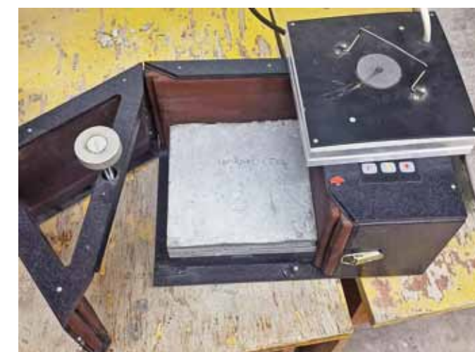
Рис. 4. Экспериментальное исследование теплопроводности образца базальтофибробетона с теплоэффективным перлитовым заполнителем
