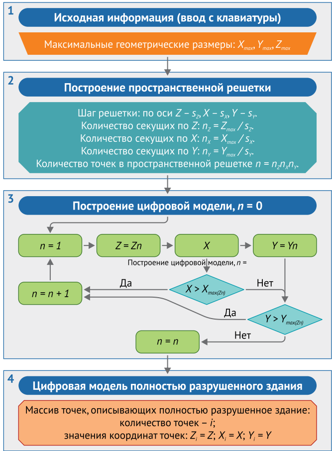
Рис. 2. Принципиальная блок-схема построения цифровой модели полностью разрушенного здания Fig. 2. Schematic block diagram of building a digital model of a completely destroyed building
