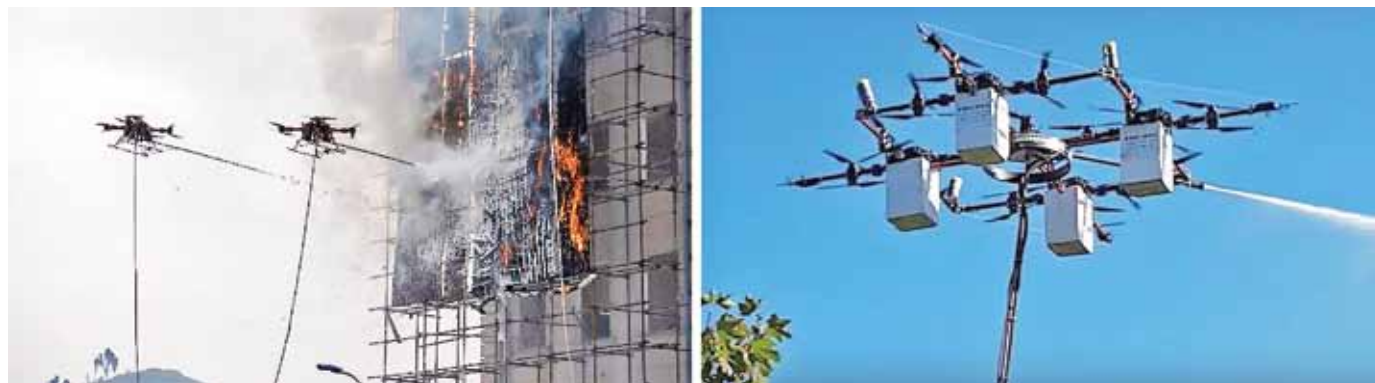
Рис. 6. Применение БПЛА при пожаротушении Fig. 6. Use of UAVs in firefighting
