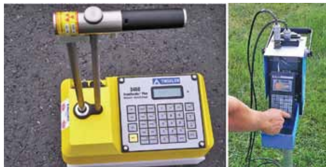
Рис. 4. Влагоплотномеры грунтов радиоизотопные: а) плотномер (источник: https://www.institutdrhaag.de/ ), б) нейтронный влагомер (источник: https://kimaro.com.sg/ ) Fig. 4. Nuclear gauges for the measurement of soil moisture content and density: a) density meter (source: https://www.institutdrhaag.de/ ), b) neutron moisture meter (source: https://kimaro.com.sg/ )
