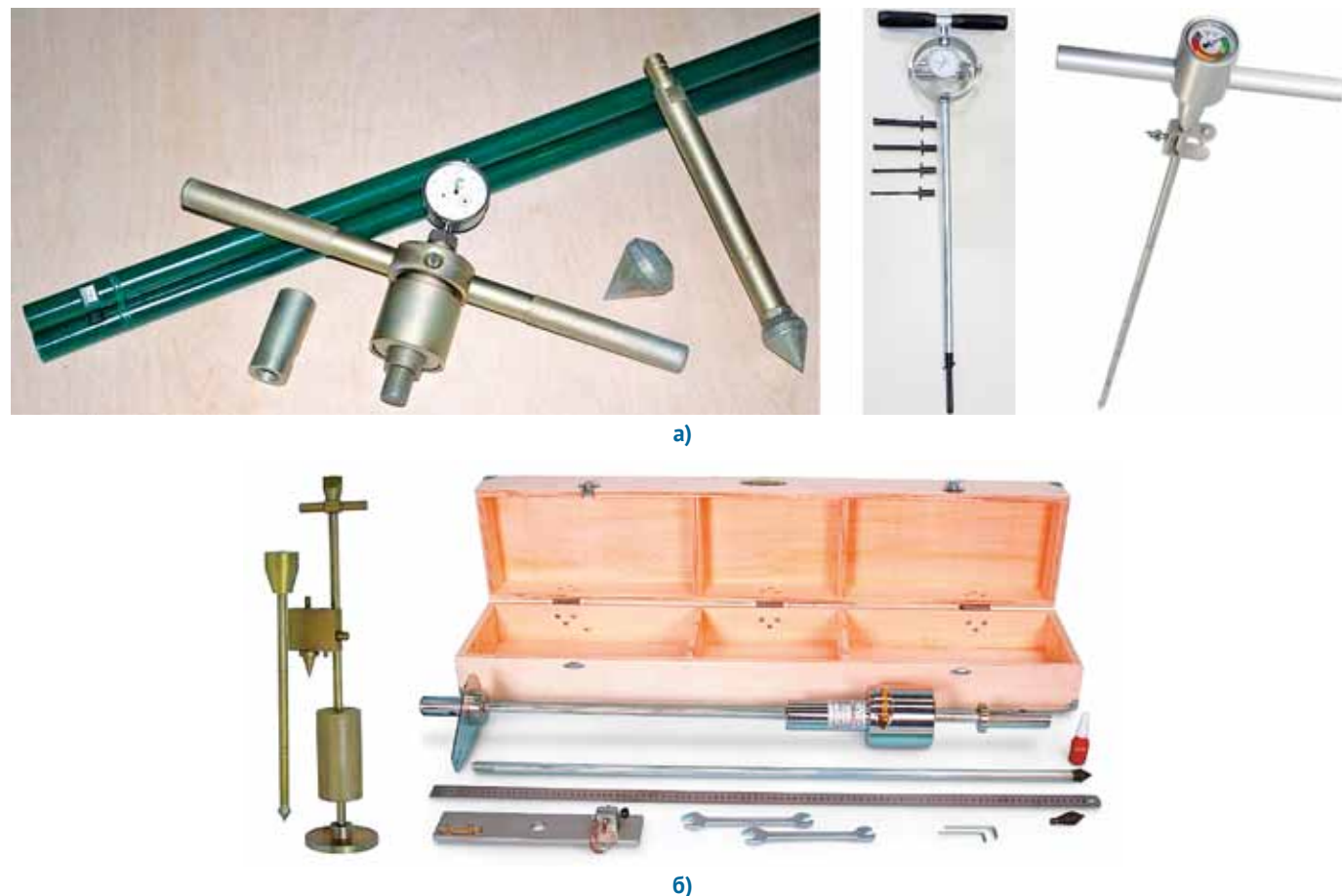
Рис. 1. Пенетromетры для оперативного контроля качества уплотнения: а) статический (источник: https://geotest.ru/ ), б) динамический (источник: https://geobond.ru/ ) Fig. 1. Penetrometers for quick response quality control of compaction: a) static (source: https://geotest.ru/ ), b) dynamic (source: https://geobond.ru/ )
