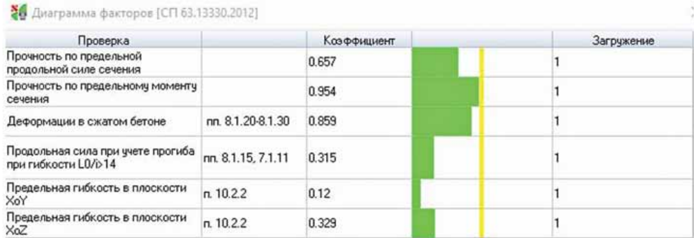
Рис. 3. Диаграмма факторов для наиболее нагруженного пилона типового этажа Fig. 3 Factor diagram for the most loaded pylon of a typical floor
