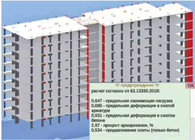
Рис. 2. Сгенерированные сечения монолитных конструкций в ПО Prometey (серым цветом отмечены откорректированные сечения, красным – первоначальные сечения) Fig. 2 Generated sections of monolithic structures in Prometey software (corrected sections are marked in gray, original sections are marked in red)
