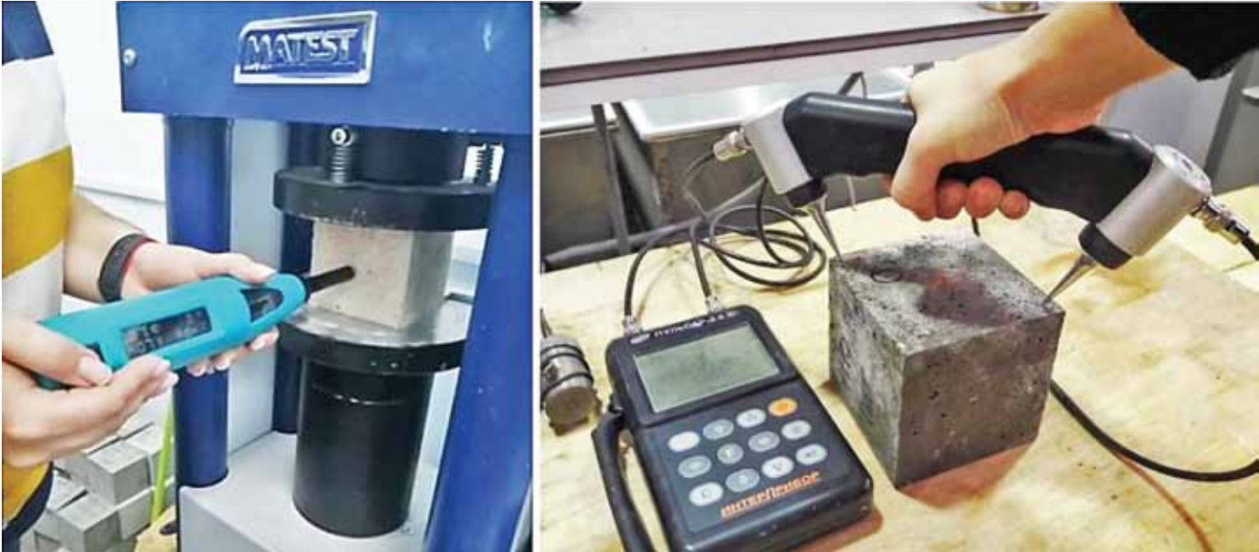
Рис. 5. Проведение испытаний: а) испытания методом упругого отскока; б) ультразвуком Fig. 5. Carrying out tests: a) testing by the elastic rebound method; b) ultrasound
