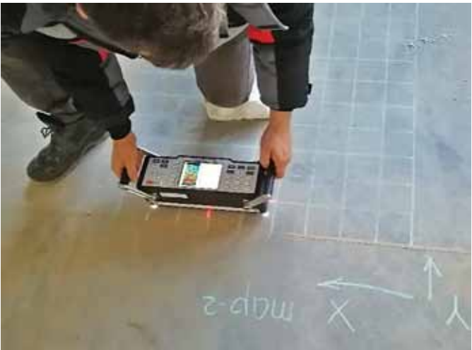
Рис. 6. Испытание ультразвуковым томографом A1040 MIRA Fig. 6. Testing with ultrasonic tomograph A1040 MIRA
