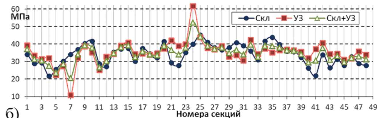
Рис. 9. а) Результаты испытаний неразрушающими методами (Скл – склерометр, УЗ – ультразвук); б) значения прочности в сечениях фибробетонного пола Fig. 9. а) Test results using non-destructive methods (Skl – sclerometer, US – ultrasound); б) strength values in sections of fiber reinforced concrete floors
