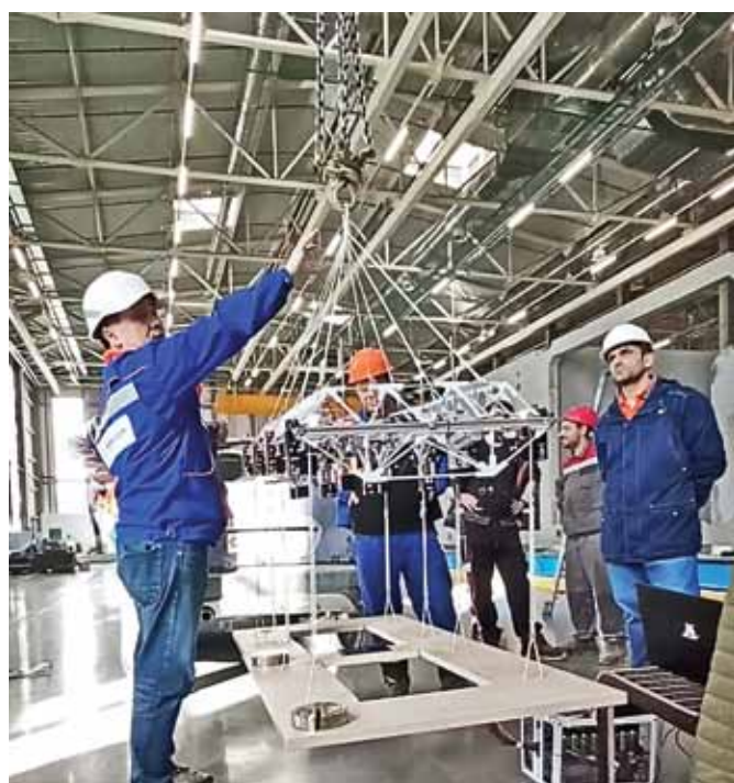
Рис. 4. Действующий макет прототипа роботизированного специализированного монтажного оборудования Fig. 4. The current mock-up is a prototype of robotic specialized mounting equipment
